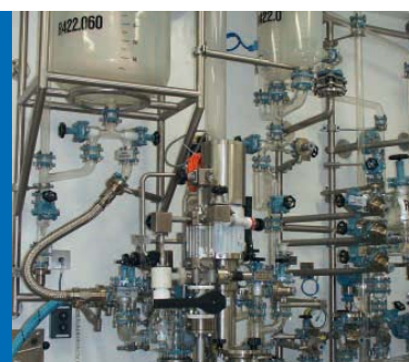
Reactor for high active pharmaceutical ingredients Reaktor für hochaktive pharmazeutische Wirkstoffe
