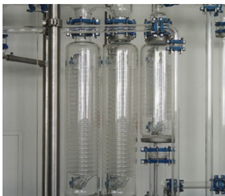
Glass-spiral condensers in parallel configuration Glas-Spiralkondensatoren in paralleler Anordnung
